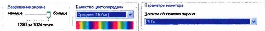
Рис. 3.4. Элементы интерфейса в диалоговом окне Свойства экрана (OS Windows), позволяющие установить требуемый режим работы монитора
