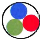
Рис. 3.3. Пиксель состоит из трёх точек красного, зелёного и синего цветов
