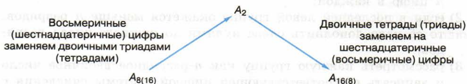
Рис. 3.4. Схема перевода целых чисел из восьмеричной системы счисления в шестнадцатеричную и обратно через двоичную систему счисления
