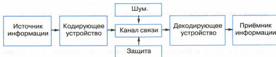
Рис. 1.13. Схема передачи информации по техническим каналам связи
